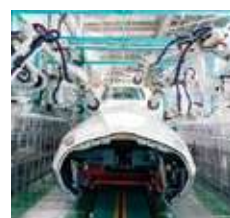
世界中で使われている塗装機の多くは島田生まれ。そしてロボット自動化のメリットを生かし、ABB ジャパンは自動車だけでなく写真の新幹線の研磨作業の自動化のように、幅広い分野に貢献しています！
