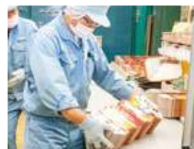
ウェストロック内のグローバル拠点で設計されたパッケージを、アメリカ製の印刷機で印刷。その後インライン検査機を通し、最後の品質チェックは人の目で。日本ならではの徹底した品質管理は大手食品メーカーからの信頼を集めます。
